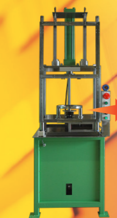
焼結体抜き出し装置
